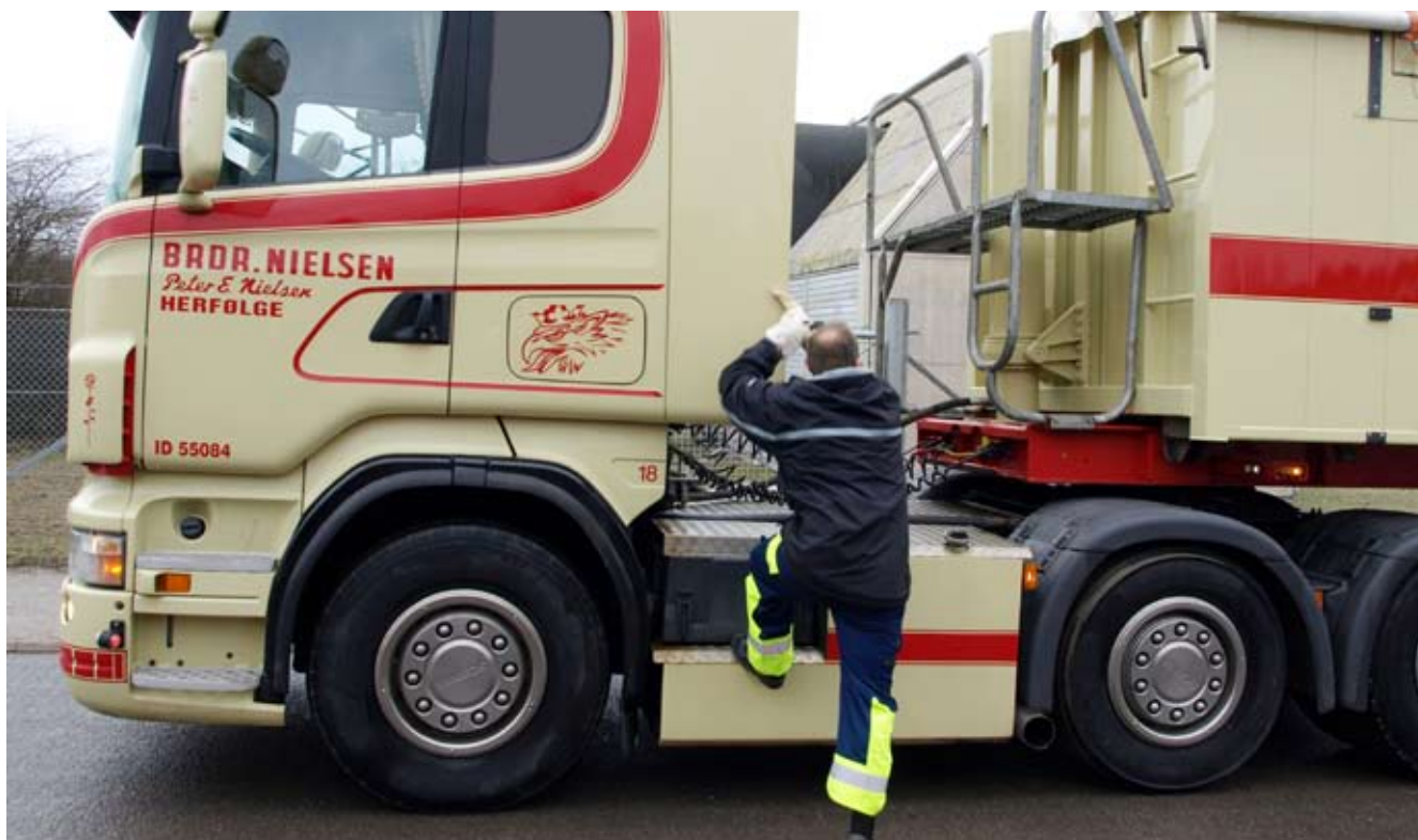
Et godt eksempel på en fornuftig adgangsvej, både på trækket og på traileren, og med god arbejdsstandplads på traileren.
