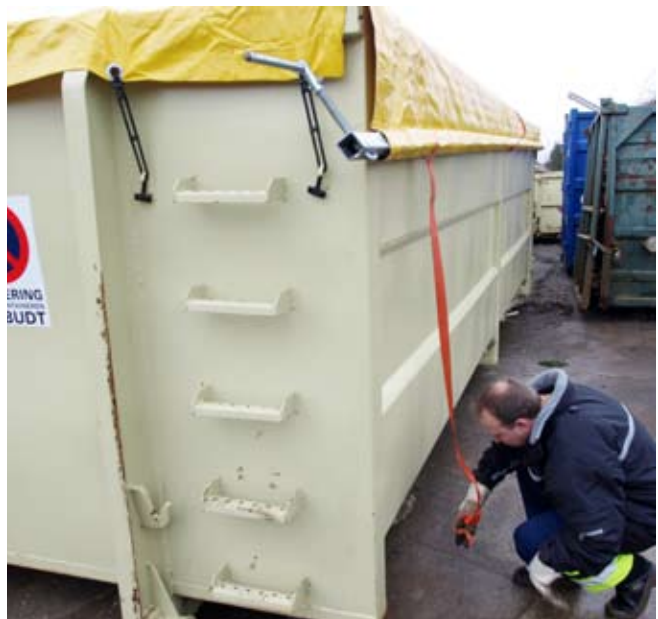
Står containeren på jorden, kan man klare arbejdet fra jorden – hvis det er en lav container.
