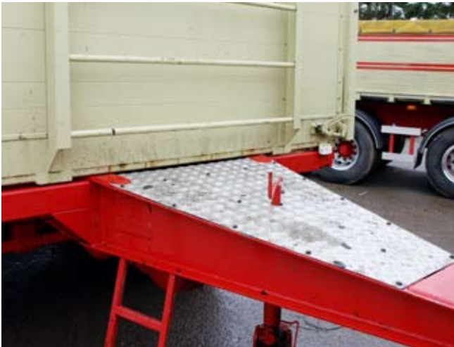
Et godt eksempel på skridsikker belægning og fastmonteret trin.
