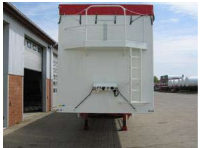
Denne løsning gør det muligt at stå godt under arbejdet med presenningen, og arbejdet kan foregå i god arbejdshøjde. Risiko for faldulykker er reduceret.
